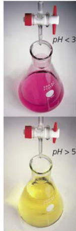
Farbumschlag des Indikators Methylorange Aus: Brown, T. L., LeMay, H. E. & Bursten, E. B. (2007)
