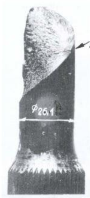
Dauerbruch einer Welle unter Torsionsschwingung
