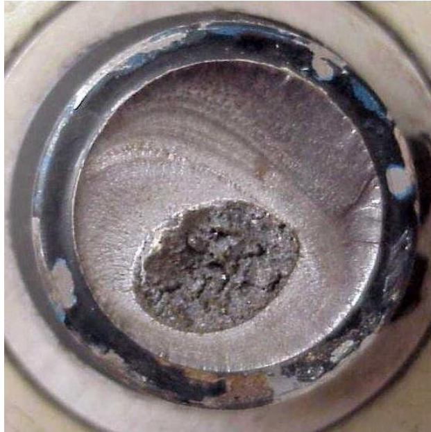
Dauerbruch einer Welle unter Biegung und Torsion
