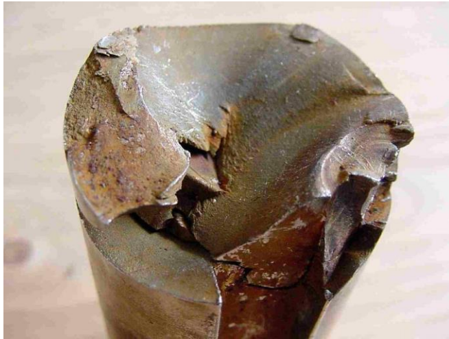
Torsionsbruch an einer Antriebswelle
