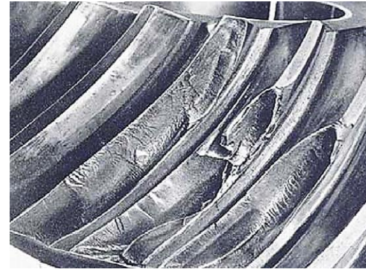
Ermüdungsbruch am Radkranz
