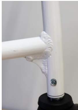
Schweißverbindung am Rollstuhl
