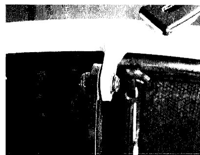
formschlüssige Schraubverbindung am Rollstuhl
