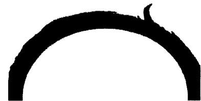
Abbildung 9.5 Durch Extrusion beschädigter O-Ring
