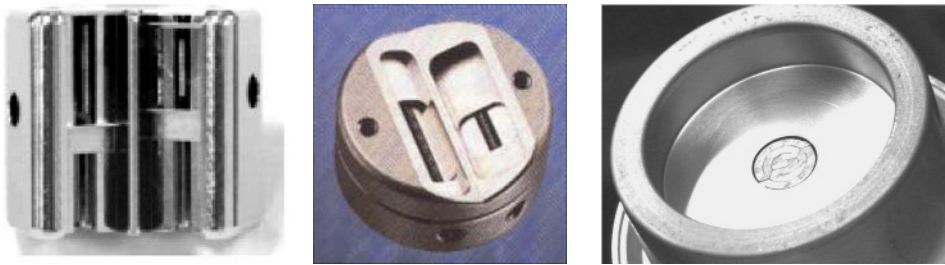
Fig. 3.2: Kathodenbauformen für Röntgenröhren. Links und Mitte: Konventionelle Wolframwendeln in Wehneltzylindern als Glühkathoden für große und kleine Strahlleistungen (Masse der Glühwendeln bis 250 mg, Oberfläche bis 100 \text{ mm}^2 ). Rechts: Kompakte Glühwendel in Flachbauweise in der Kathode der Drehkolbenröhre mit sehr niedriger Wärmekapazität, die eine besonders schnelle Anpassung des Elektronenstroms an die Objektdurchmesser in der modernen Computertomografie ermöglicht. Ihre Masse beträgt nur 37 mg bei einer Oberfläche von etwa 40 \text{ mm}^2 (nach [Schardt], mit freundlicher Genehmigung durch die Autoren).
