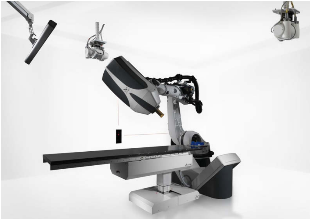
Fig. 9.31: Gesamtansicht des Cyberknife-Systems. Es besteht aus einem 6-MeV-Elektronenbeschleuniger, einem Industrieroboterarm (Masse etwa 1,2 t), einem zweidimensionalen Verifikationssystem mit zwei externen Röntgenröhren, Flachbilddetektoren und einem 3D-Videosystem mit 3 Kameras (links oben), die am Patienten befestigte Marker vermessen. Dies dient zur Nachlaufsteuerung des Strahlerkopfes bei Atembewegungen des Patienten (Photo mit freundlicher Genehmigung der Fa. Accuray).
