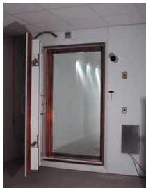
AK3B Vakuumschmelze: 3 Layer shielding
