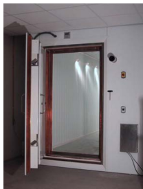
AK3B Vakuumschmelze: 3 Layer shielding
