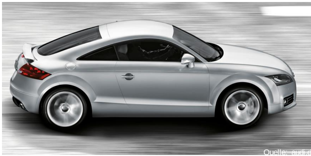
Horizontale Abrisskante mit feststehendem Spoiler
