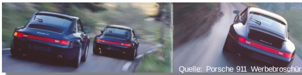
Horizontale Abrisskante je nach Fahrgeschwindigkeit
