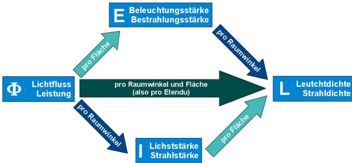
Abbildung 7.1.4: Photometrische (radiometrische) Größen ergeben sich jeweils durch Angabe des Lichtfluss (bzw. der Leistung) pro Raumwinkel und/oder pro Fläche. Bild nach W.J. Cassarly, “Nonimaging Optics”.
