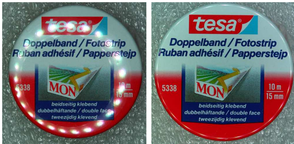
(a) Ringlicht in falscher Höhe: starke Störreflexe aufgrund der einzelnen Ringlicht-LEDs (b) sinnvolle Höhe: die Reflexionen sind reduziert und liegen in wenig störenden Bereichen
