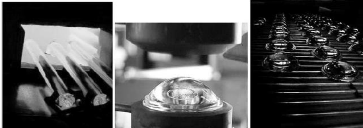
Abb. 2.11. Herstellverfahren für blankgepresste Optik. Von links nach rechts: 1. Erwärmen des Glases im Ofen. 2. Fertige Linse nach dem Öffnen des Umformwerkzeuges. 3. Abkühlen der Linsen außerhalb des Umformwerkzeuges (Werkfoto: Docter Optics)
