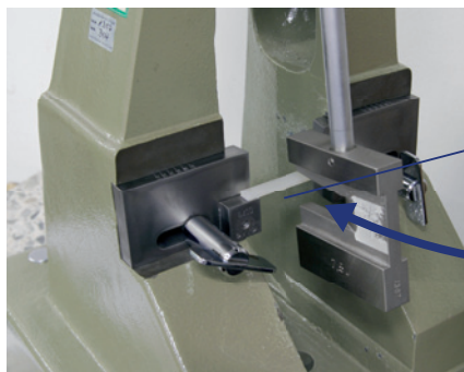
Bild 3.56 Schlagbiegeversuch nach Charpy am IKT
