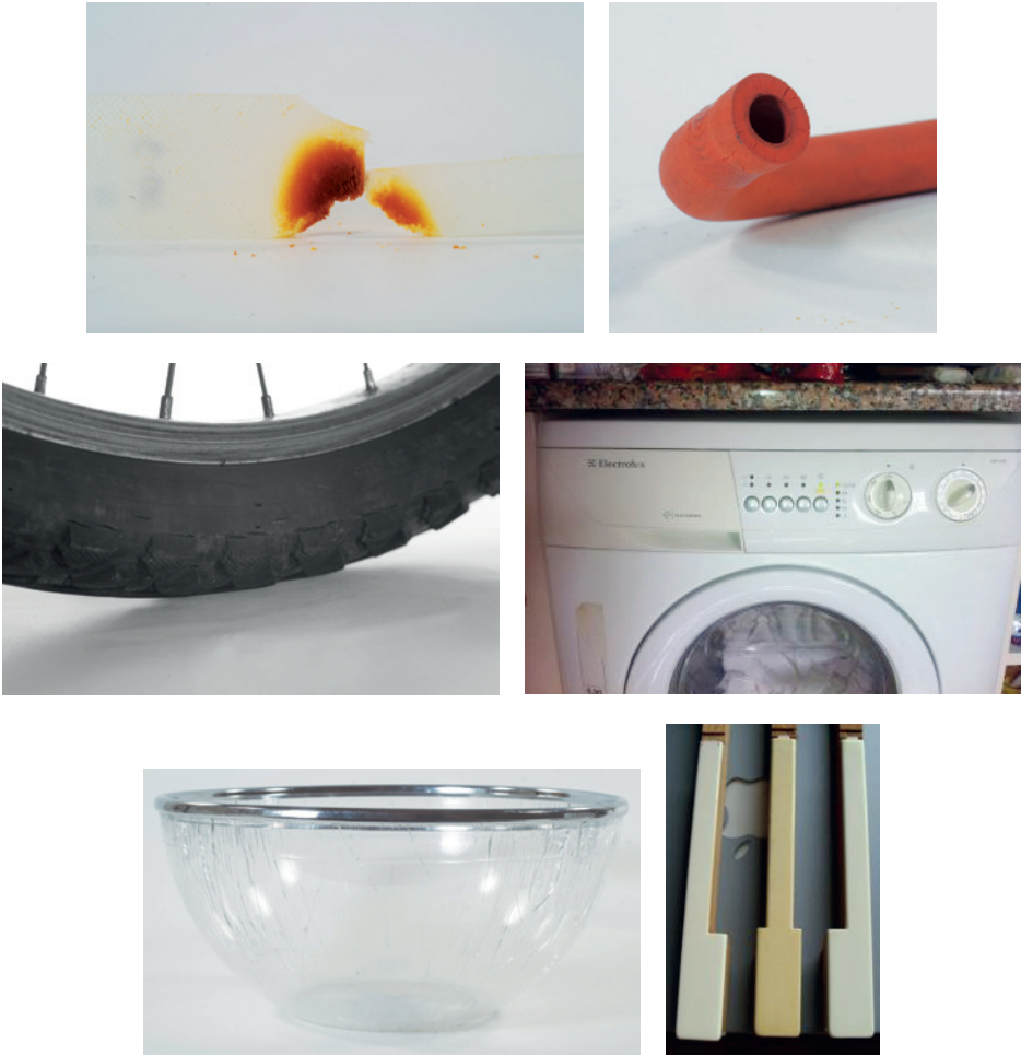
Bild 3.150 Äußerlich erkennbare Alterungserscheinungen
