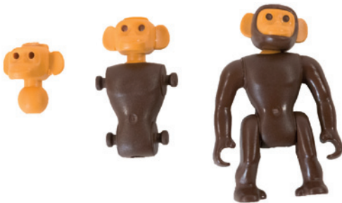
Bild 4.68 Montage-Spritzgießen einer Spielfigur
