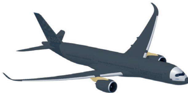
Bild 3.94 Teile der Außenhaut des A 350 sind aus Faserkunststoffverbund (grau); [Bildquelle: Airbus AG]
