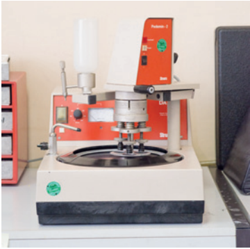
Bild 4.122 Poliermaschine in der Schadensanalyse des IKT
