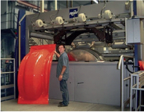
Bild 4.114 Positiv-Formverfahren [Bildquelle: Frimo]
