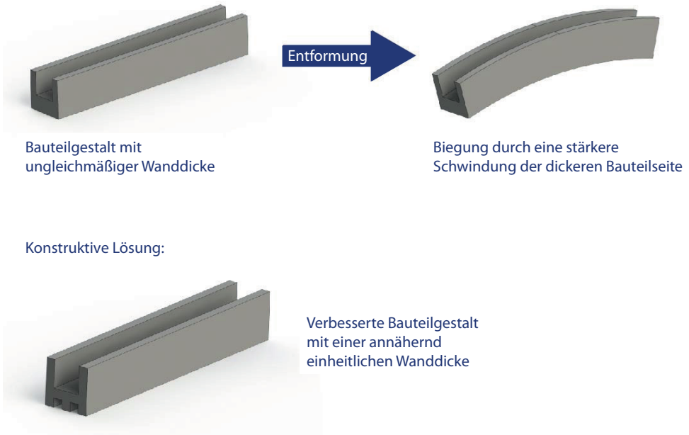
Bild 5.31 Verzug zum zuletzt erstarrten Volumenlement hin
