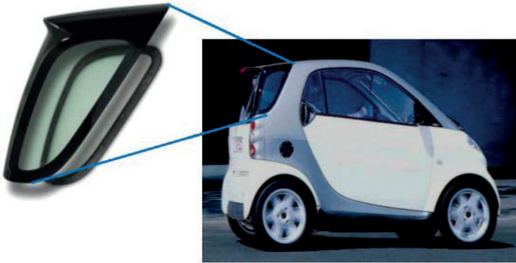
Bild 4.152 Anwendungsbeispiel einer kratzfesten Kunststoffoberfläche [Bildquelle: Daimler AG]
