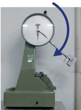
Bild 3.56 Schlagbiegeversuch nach Charpy am IKT
