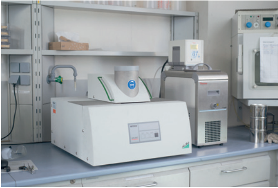
Bild 3.85 Nano-Flash-Messgerät am IKT
