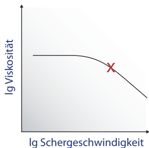
Bild 3.28 MFR-Wert ist nur ein Punkt auf der Viskositätskurve
