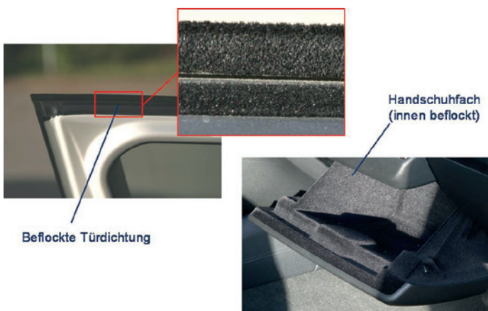
Bild 4.155 Veränderung des Reibbeiwerts durch Beflockung
