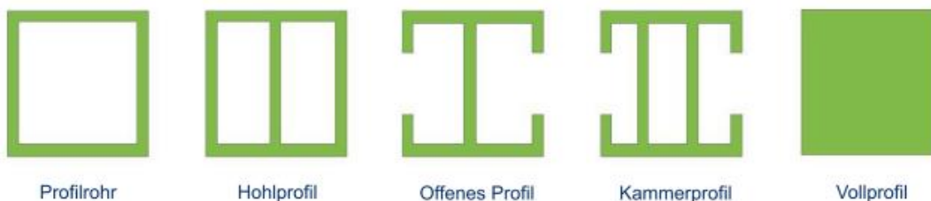
Gängige Profiltypen (Querschnitt)
