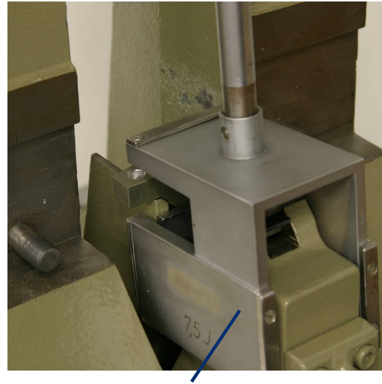
Schlagpendel (schlägt gegen das Querjoch und zieht damit an Probe)
