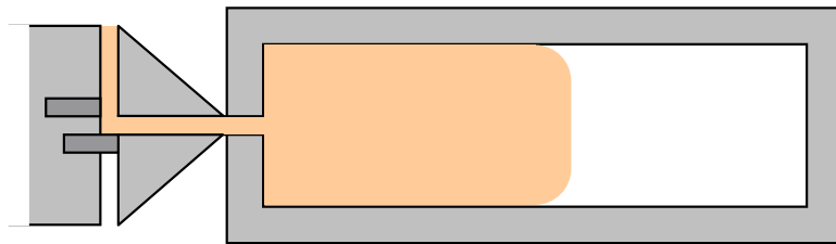
1. Einspritzen des Hautmaterials (Teilfüllung)
