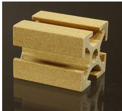
Bauprofil mit Naturfaser
