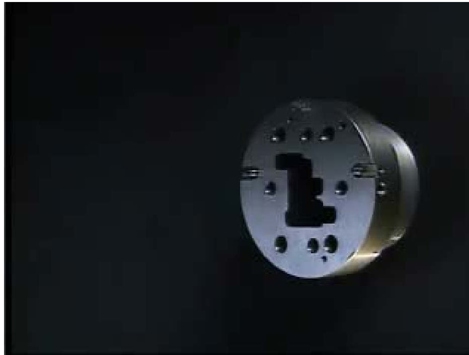
Greiner Extrusion Aufbau einer Extrusionsdüse für Fensterprofile
