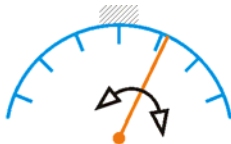
Anzeiger mit fester Skala und bewegtem Zeiger
