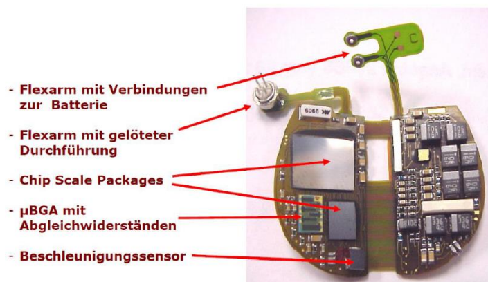
Bipolare Durchführung an Flexausleger angelötet
