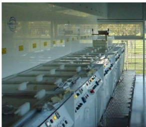
Metallisierungsanlage: Arbeitsvolumen ca. 30 L
