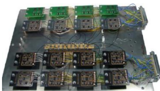
1. Testaufbau mit 480 Anschlüssen
