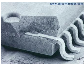
Chip-Out bei Plastic Packages
