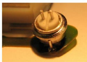
Bipolare Durchführung an Flexausleger angelötet
