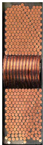
Abb. 2.14: Schliffbild einer realen Wicklung
