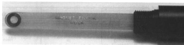
Feldspulen für die Messung der magnetischen Feldstärke H , bzw. Flussdichte B . Windungsfläche: 100 \text{ cm}^2 / Abmessungen: 8 \text{ mm } \varnothing \cdot 1,8 \text{ mm} .
