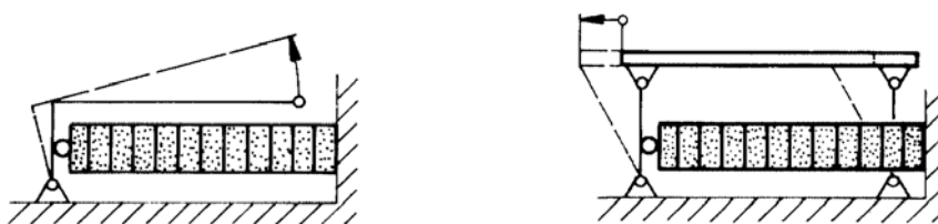
Abb. 5.14: Stapelwandler mit Hebelübersetzung (rechts mit integrierter Geradföhrung /29/)
