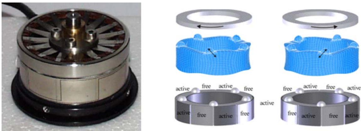
Abb. 5.24: Rotatorischer Stehwellenantrieb mit axialer Dehnungsmode /41/
