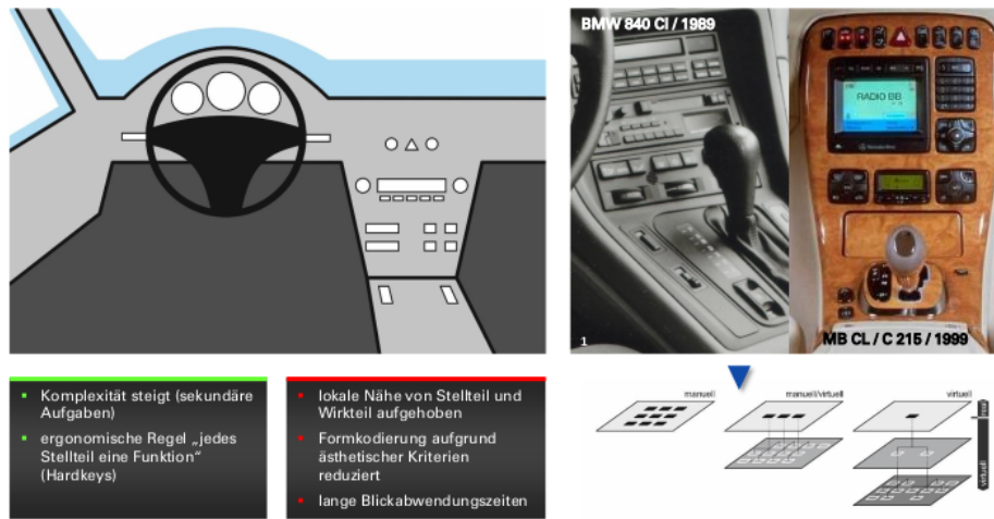
Figure 4: 2. Phase der Fahrzeugcockpitentwicklung: Bedienelemente nehmen große Fläche ein
