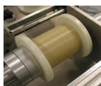
Resorb. Monofil mit 2 % Nanosilber
