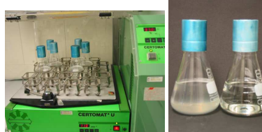
Shake-flask Test auf antibakterielle Wirksamkeit
