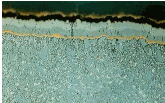
CVD-Schicht auf Hartmetall (Schliff)
