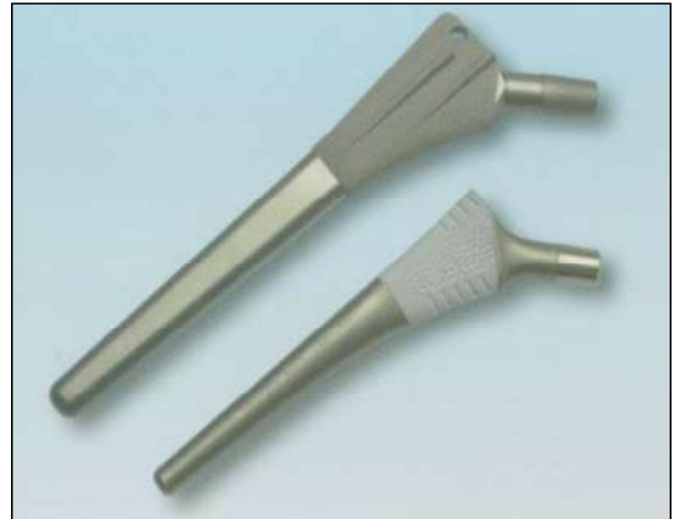
Thermisch gespritzte HAp Schicht auf einer Ti Prothese
