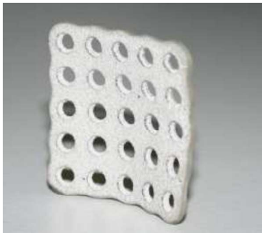
Schichtverbund nach der biegenden Formgebung bei 70 °C
